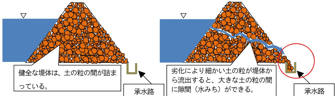
図6：土の細粒分が流出するイメージ
