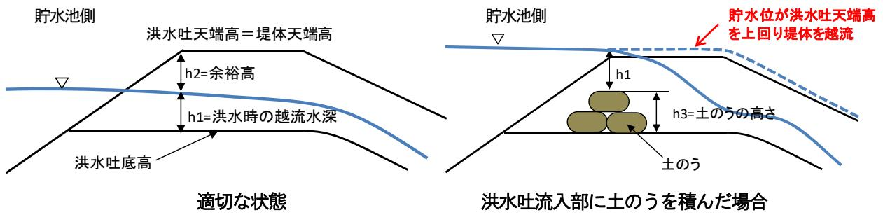
図 10：洪水時の水位の違いのイメージ
