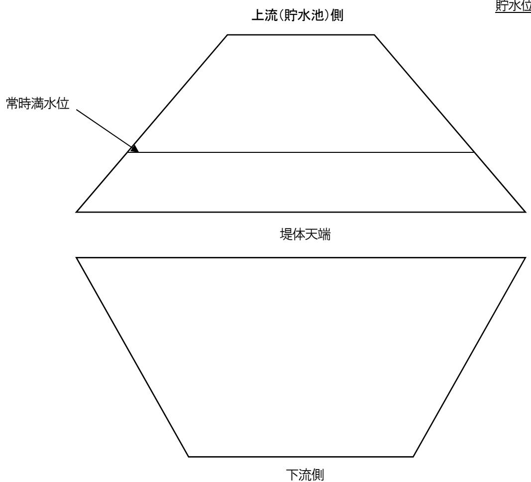
※図に変状箇所をスケッチし、変状箇所に番号を付し、その大きさと状況を記載する。
