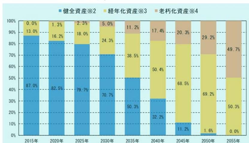
図 4.5 上水道及び簡易水道・小規模水道における管路の健全度
