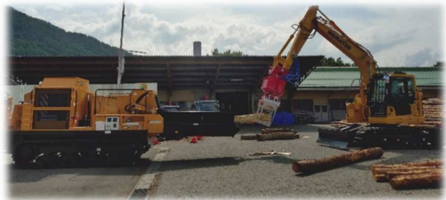
木材破砕機（チップパー） 油圧ショベル 切削チップ製造 チップサイズ 1.6 cmから 6.3 cm
