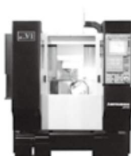
▲加工に使用している 5軸マシニングセンター
