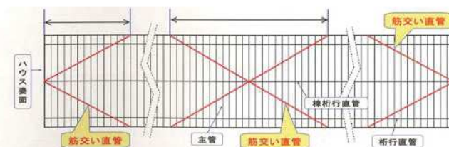
筋交いによる妻面の補強方法事例
