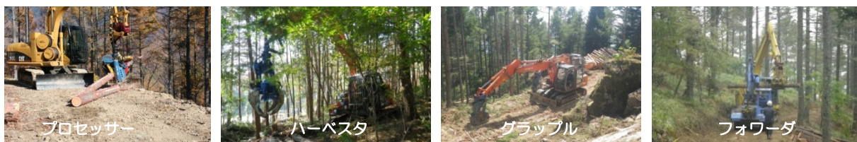
写真 1-2-1 伊那市内で稼働する高性能林業機械
