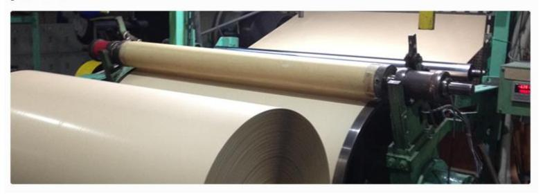
抄紙機にてパルプを均一に伸ばし、間伐材和紙の原紙を作ります。 その後、スリット加工という、和紙をI~4mmの幅に細かく裁断し、スパイラ ル状に巻き取り撚糸します。ここで木糸の完成です。
